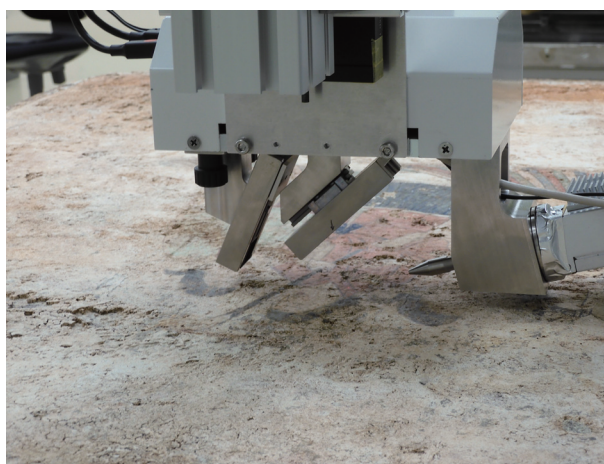
図5 小型X線回折分析装置を用いた西壁女子群像の分析調査
