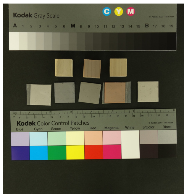
消火薬剤を塗布した金属試料と木材試料
