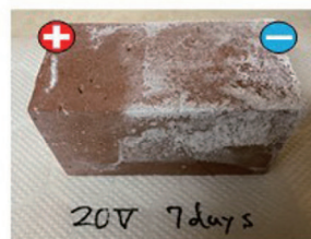
b. 20V 7日間通電 (濃度拡散 + 電気泳動)
