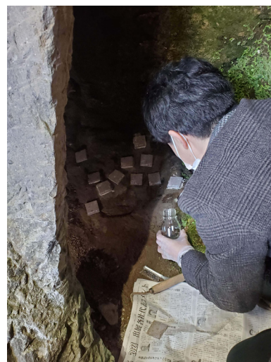
臼杵磨崖仏での接着剤選定試験
