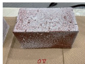
脱塩実験後のレンガの様子
