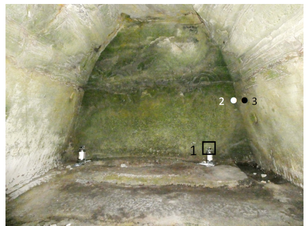
直牒洞における計測 緑色生物の繁茂が著しい地点2と、乏しい地点3とで照度条件を比較し、また洞内での年間積算照度を1地点で計測することで、緑色生物繁茂の閾値を推測した。
