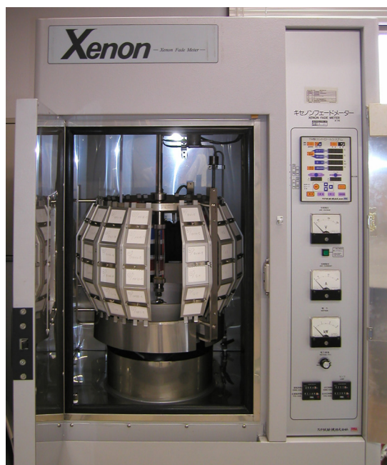
露光試験に用いるキセノンフェードメータの例
