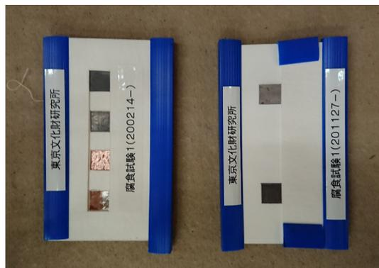
金属試料を用いた暴露試験
