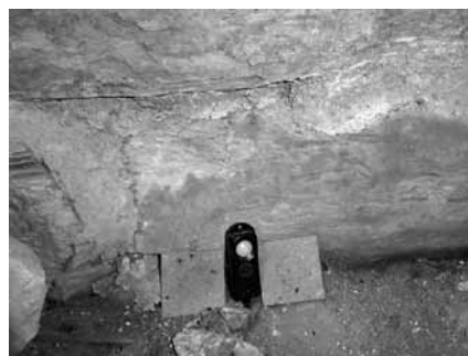
現地に設置されたセンサーと テストピース
