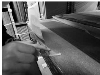
文化財展示収蔵施設でのATP測定
