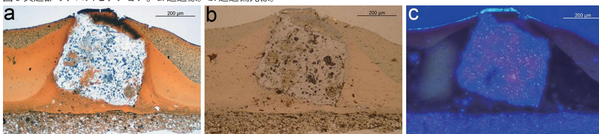
図6 突起部のクロスセクション。a: 透過像。b: 反射像。c: UV 像。
