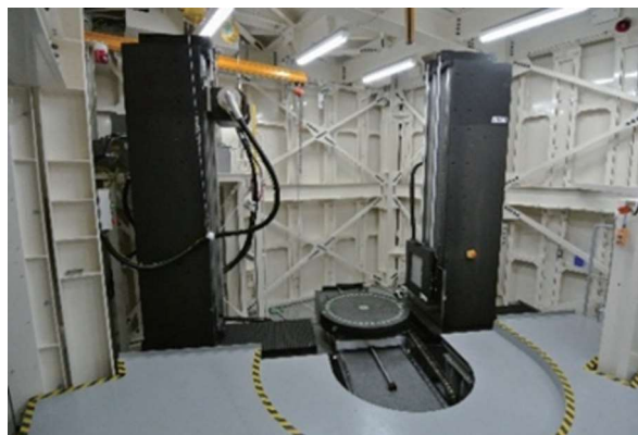
図2 今回の撮影に使用したエックス線 CT スキャナー。直径 2.5 m、高さ 2.5 m、500 kg の文化財を台車ごと搬入設置し、立てたまま撮影可能。世界最大級の文化財用 CT。X 線発生能力：600 kv（80 mm の純鉄を断層撮影が可能）。
