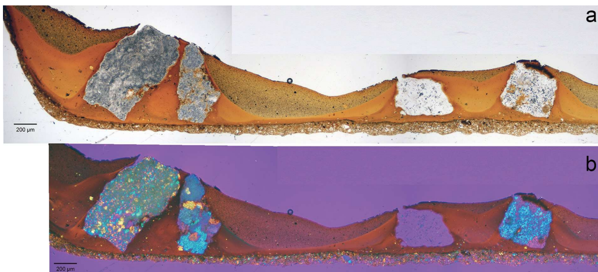
図5 突起部のクロスセクション。a: 透過像。b: 透過偏光像。
