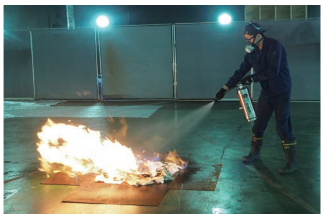
粘性水消火器による油火災消火実験（能見防災研究所）
