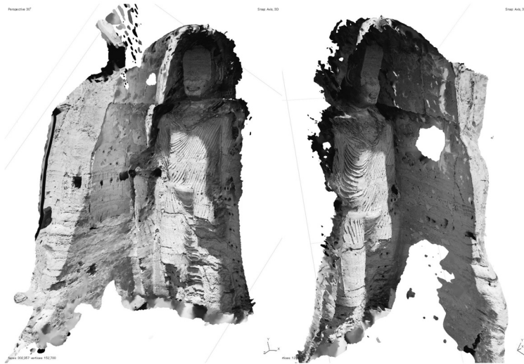
図5 パーミヤーン西大仏の三次元空間画像（側面 左：向かって右側面から見たもの、右：向かって左側面を浅い角度から見たもの） ※西大仏本体が見えるよう、三次元空間画像から仏龕を一部消去
