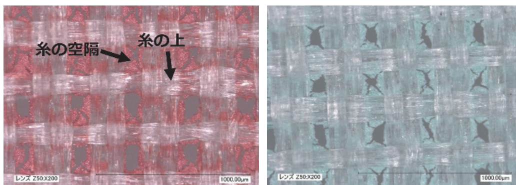
写真14 試料 a 市販画絹表面デジタルマイクロ스코プ画像 裏彩色のみ
