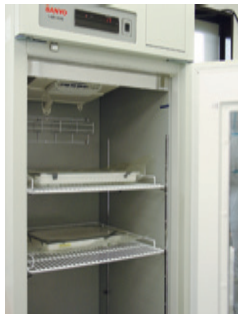
Fig. 3-16 封入した漆喰片を 17 ~ 18°C の恒温装置内に保存した。
