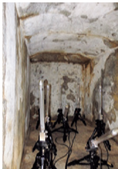
Fig. 3-88 石室内に設置した紫外線照射装置
