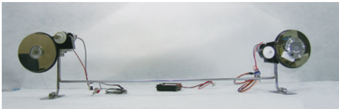
Fig. 3-69 ワイヤソー 1号機（フレームにベアリングのみを付けたテスト機）
