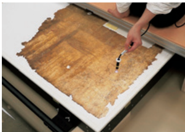
Fig. 4-27 紫外線照射により色素を分解し、酵素を使用してバイオフィームを物理的に除去
