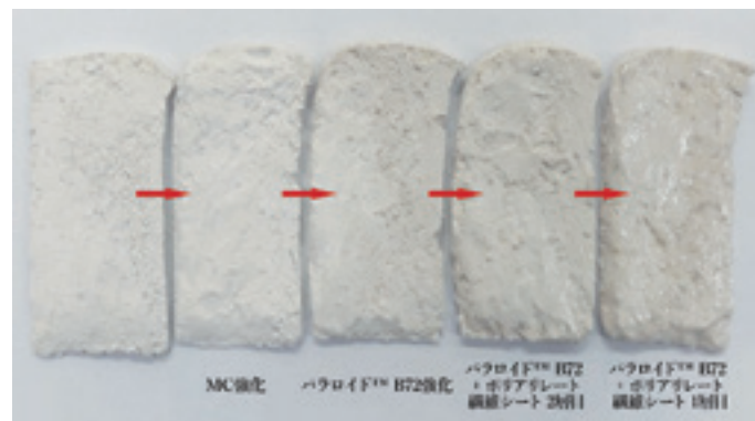
Fig. 4-2 漆喰裏面からの強化処置手順
