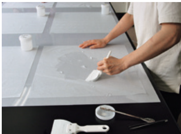
Fig. 2-16 HPC シートの作製 (レーヨン紙への HPC 塗布)
