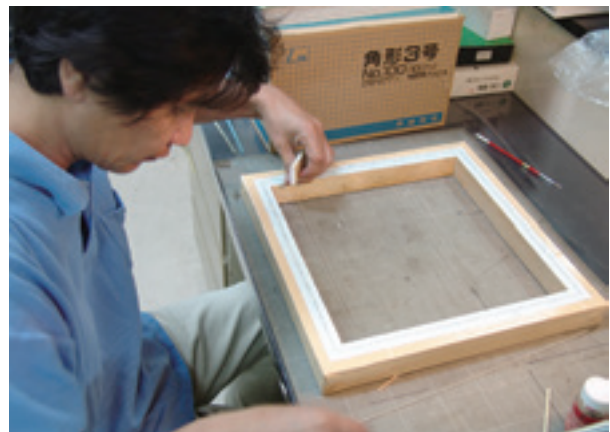
Fig. 4-7 ポリアリレート繊維シートの作製作業 (2 層目)
