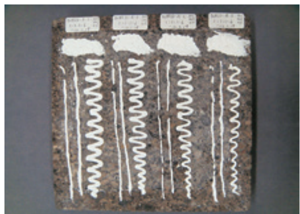
Fig. 4-23 充填剤のヘラによる塗布とシリンジによる絞り出し
