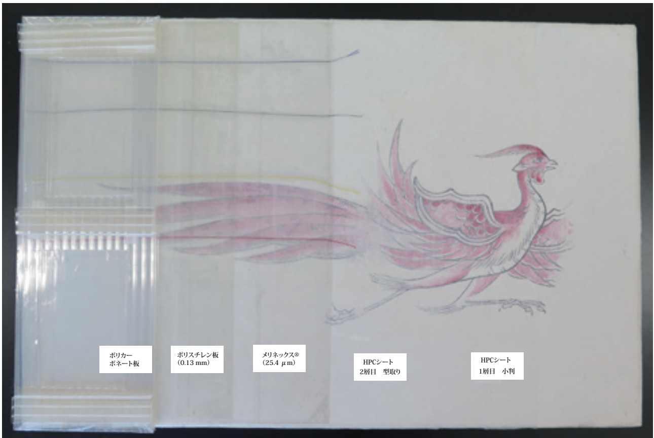
Fig. 3-64 取り外し作業における画面保護の構造模型（朱雀）
