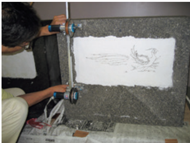
Fig. 3-60 朱雀の取り外しを想定したワイヤーソーの実験
