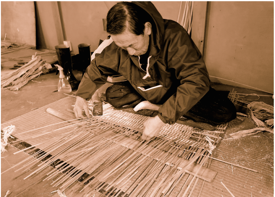
ミダチを使ってフジをヤダケの間に叩きこみ、その下に薄くへいだヤダケを挟む
