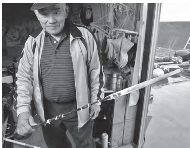
14. アワビ棹につけた竹製のホテ。ホテはバネの役目をする竹材。明治・大正の頃は弾力性のあるヒゲクジラのヒゲを用いていた。今日では竹のホテを作れる漁師は少なくなった（H25年10月、泊里の作業小屋で）
