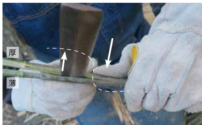
図2-9 厚さの調整 厚い方の材を左手で押し、右手の刃物は手前に引き寄せる。この時、刃物（手首）は返さず、垂直に上下させる。手前が薄い場合は左手を手前に引っ張り、刃物を向うに押し出す
