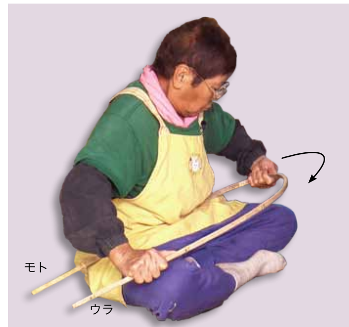
図4-2 ウデギをU字状に曲げる
