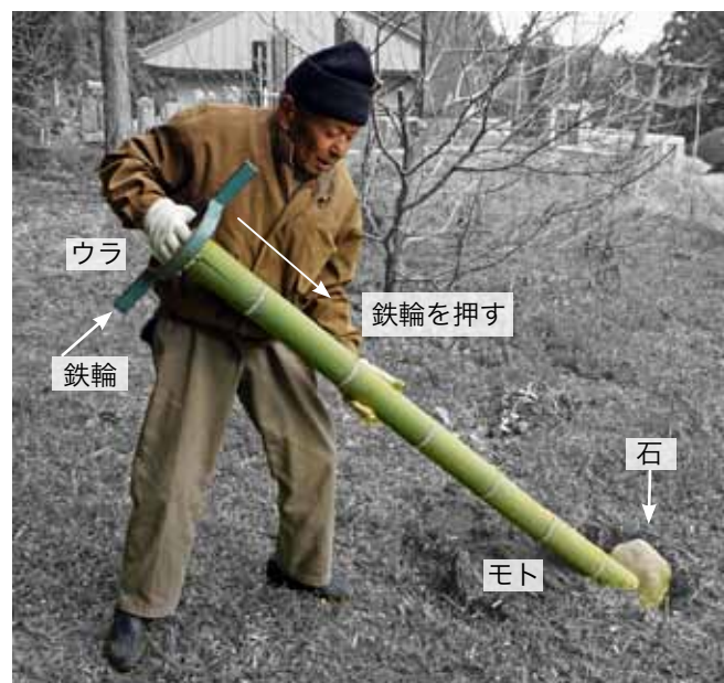
図2-37a 四ッ割り 鉄輪で四ッ割りにする かつては鉈で割っていた
