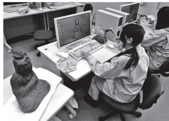
図9 CADソフトによる3Dデータの修正作業
