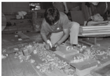
14. クレ（側板）の外側を削る
