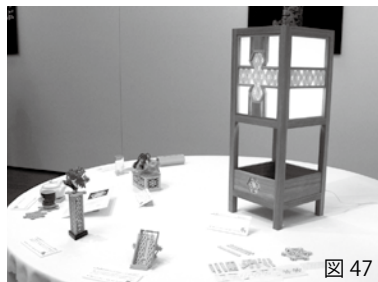
組子建具 山川英夫 ノコギリやノミなどを駆使して細かく削った木片を組み合わせることで、様々な模様を製作するという日本建築ならではの装飾法です。
