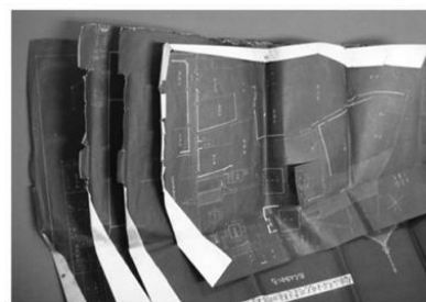
図 18 簿冊に折り畳まれる青図 折損、皺、破損が生じる例が極めて多い
