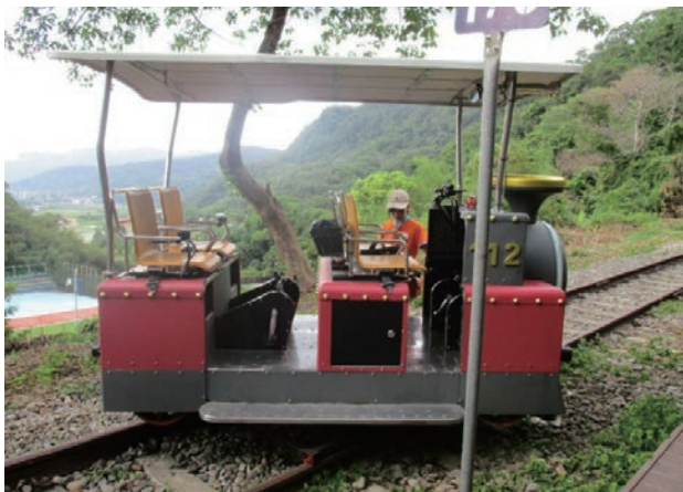
Photo120,121 終着駅では軌道電動自転車の台車が回転するため、線路区間内の往復運転が可能／ 在終點站可旋轉軌道電動自行車的平台，因此可在線路區間內來回運行
