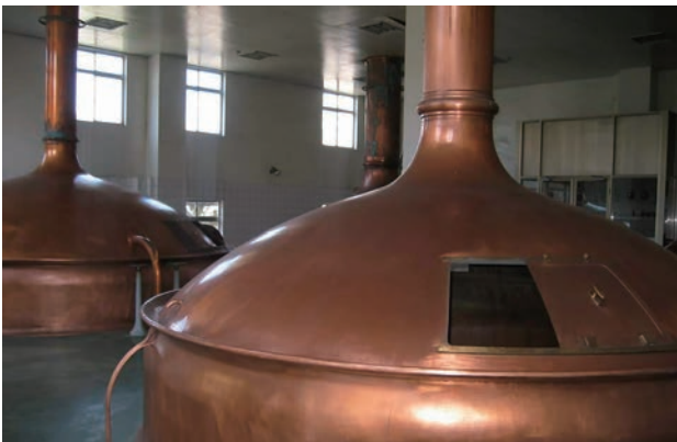
Photo76 醸造ビル内（世界で唯一稼働を続けているドイツ製の銅製の糖化釜）／醸造大樓内（全世界唯一持續運轉的德國製銅製糖化鍋）（出典／資料來源：台湾煙酒株式会社／臺灣菸酒股份有限公司）
