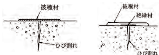
図4 ひび割れ被覆工法 3 （右：ひび割れ幅の変動が大きい場合のひび割れ被覆工法の例）
