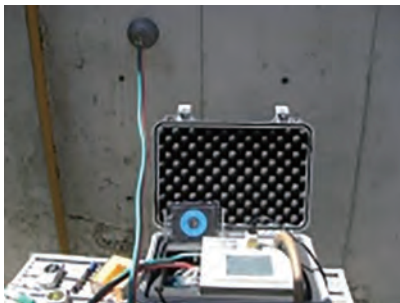
写真 7 表層透気試験調査状況
