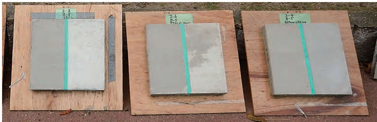
写真 2-11：3 種類の表面保護剤が塗布された補修材料で制作された試験体（左から 1 液型水系疎水剤、シラン・シロキサン系表面含浸剤＋亜硝酸系浸透防錆剤、ケイ酸塩系表面含浸剤＋亜硝酸系浸透防錆剤）写真提供 公益財団法人 文化財建造物保存技術協会
