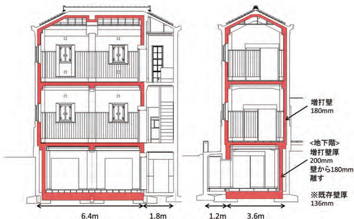
図3 愛珠幼稚園園舎附倉庫壁・屋根打ち増し、スラブ置換概要図
