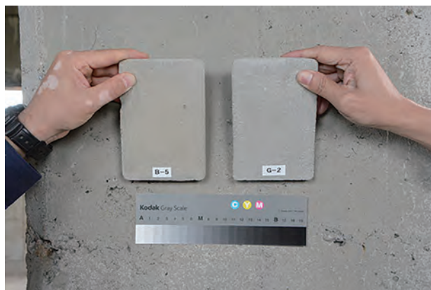
写真 2-3：調色された補修サンプル材の比較 写真提供 公益財団法人文化財建造物保存技術協会
