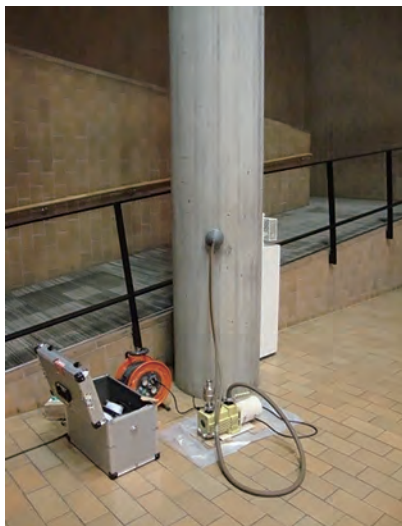
写真 9 中性化予測のための透気試験の状況
