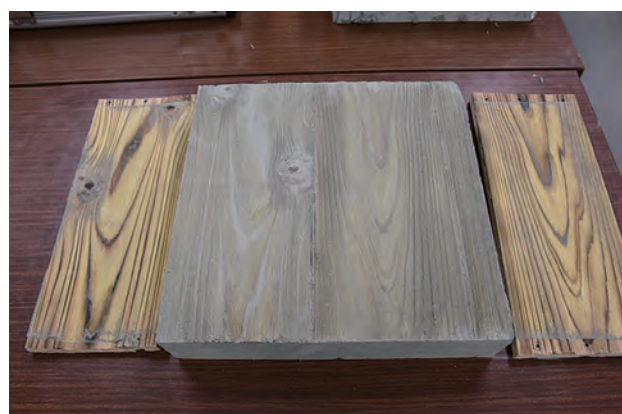
写真 5-11：表面目荒らし（浮造り）試験施工 写真提供 公益財団法人 文化財建造物保存技術協会
