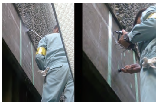
写真 11 コンクリート表面の水分撥水性検査状況
