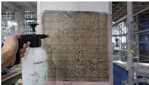
写真 7-7：モニタリング前に実施する散水 写真提供 西日本旅客鉄道株式会社
