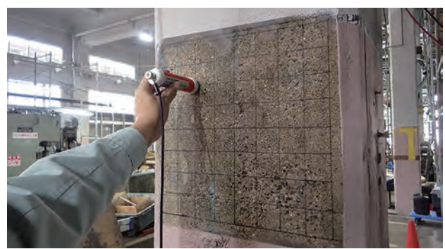
写真 7-8：自然電位測定状況 写真提供 西日本旅客鉄道株式会社
