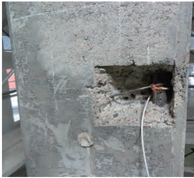
写真 7-1：内部電極設置状況 写真提供 西日本旅客鉄道株式会社
