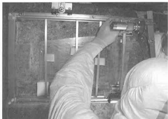
6 ダイヤモンドワイヤソーによる壁画取外し （キトラ古墳・朱雀）
