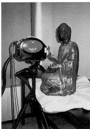
可搬型蛍光X線分析装置による仏像の表面彩色の測定
