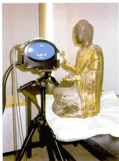
可搬型蛍光X線分析装置による仏像の表面彩色の測定
