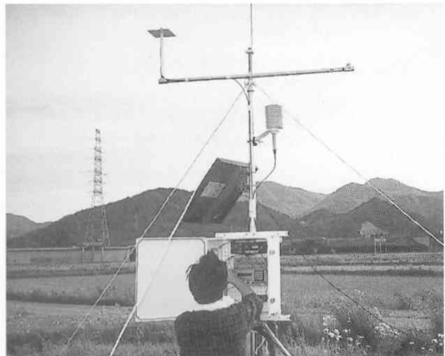
図2 岩手県志波城の築地塀近くでの気象観測装置の設置作業
