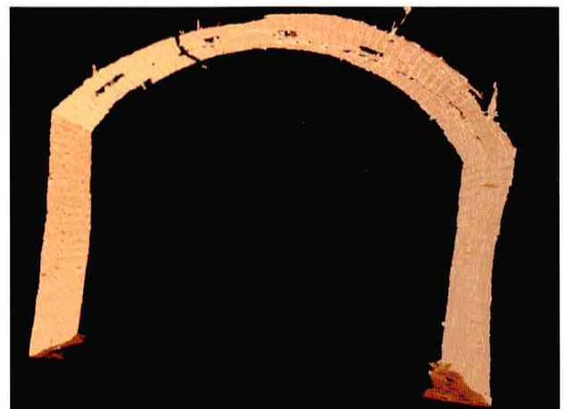
内部破損状況3D解析画像
