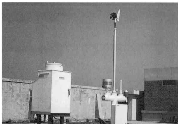
韓国国立文化財研究所で測定中の総合気象環境測定器
