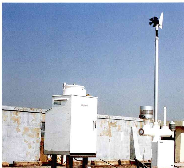
韓国国立文化財研究所で測定中の総合気象環境測定機（36頁参照）
