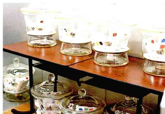
図2 顔料・金属に対する各種防虫剤、防黴剤等の影響試験
