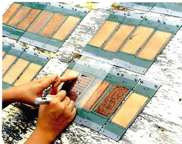
防錆処理の屋外曝露試験
