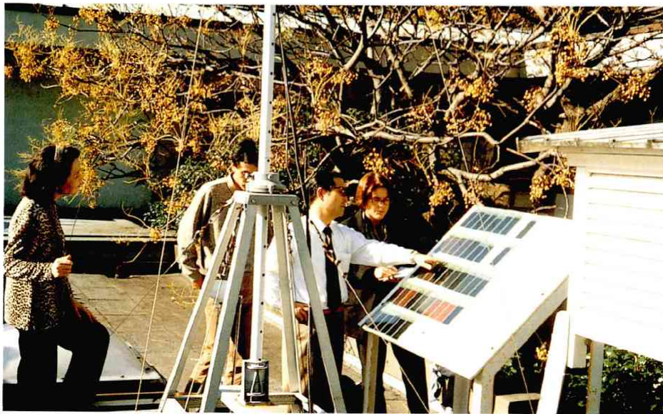
鎌倉における焼き付け漆屋外曝露試験
