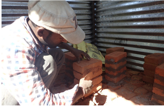
図 2-3-1 構造材料試験の試験体作成風景
