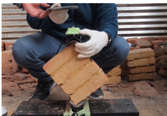
図 3-2-4 対角圧縮試験
