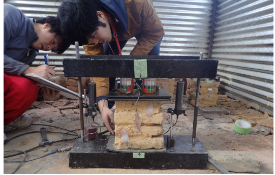
図 2-3-2 組積造試験体の一軸圧縮試験
