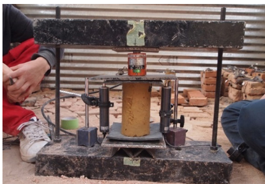
図 3-2-2 シリンダ圧縮試験の様子
