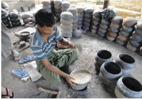
ハンマーを用いた鉄鉢の製作
