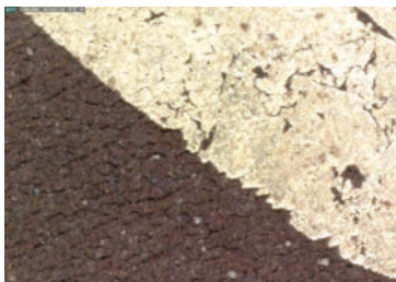
箔絵板漆塗膜と金箔の劣化
