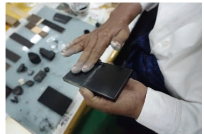
珪化木粉末での塗膜の磨き（ミャンマー）
