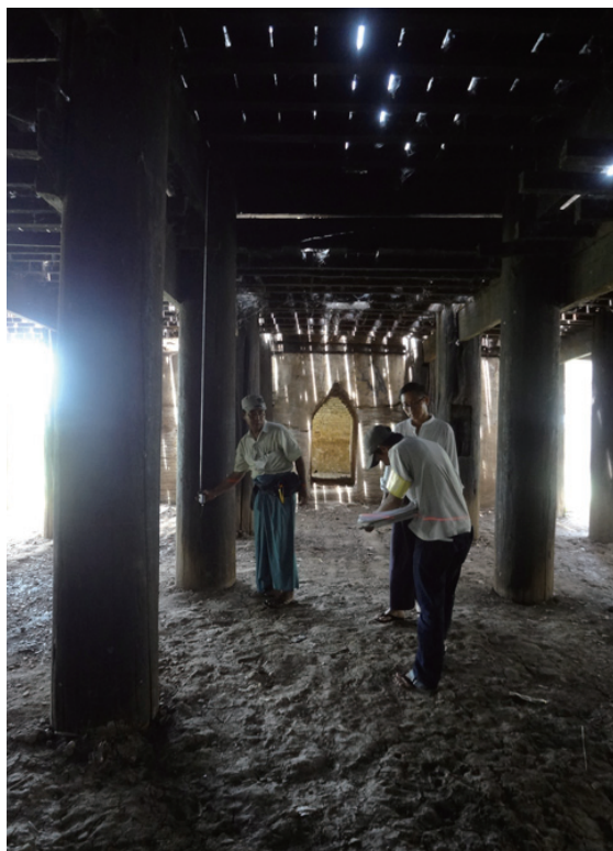
破損調査：レーザーレベルを用いた柱の傾斜計測
