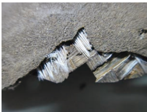
漆容器断面に劣化した竹材料の露出
