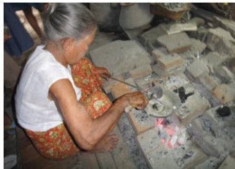
ガラスモザイク材料の鉛付け Daw Moe
