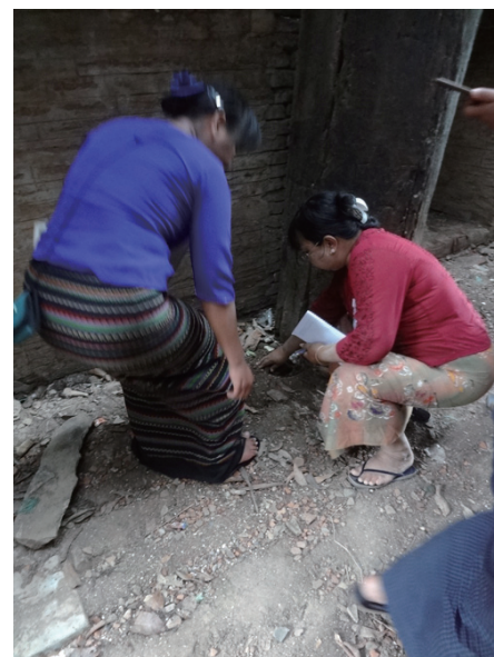
虫害調査：柱の足元に疑似餌を設置
