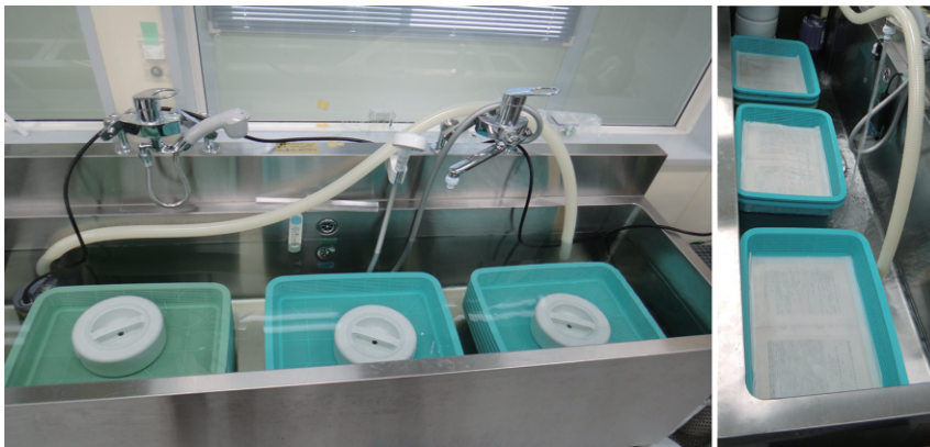
図1 脱塩工程（左：水槽に水を張った状態、右：水を張る前）
