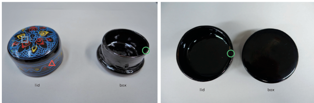
図2 資料B (左：蓋部分と箱部分，右：別アングルから撮影，赤三角部からクロスセクション用に，緑丸部から FT-IR 分析用に試料片を採取し，青四角部内の各色について蛍光X線分析を行った)
