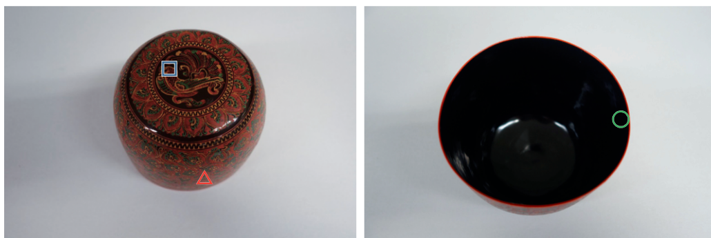
図4 資料D (左：蓋部分と箱部分，右：別アングルから撮影，赤三角部からクロスセクション用に，緑丸部から FT-IR 分析用に試料片を採取し，青四角部内の各色について蛍光X線分析を行った)
