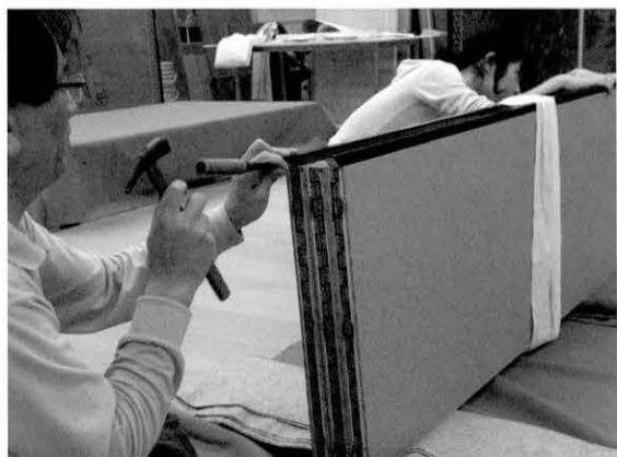
(12) 仕上げ（裏木打ち） Finishing (attaching the lacquered frame)
