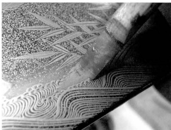
図 20 西洋塗料の除去 修復中
