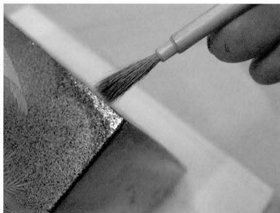
図 31 梨地の復元 毛棒による粉蒔き 修復中
