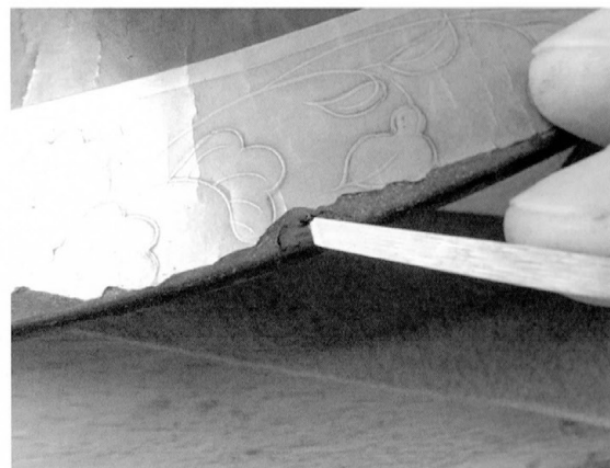
図24 刻苧付け Fig. 24 Applying kokuso
