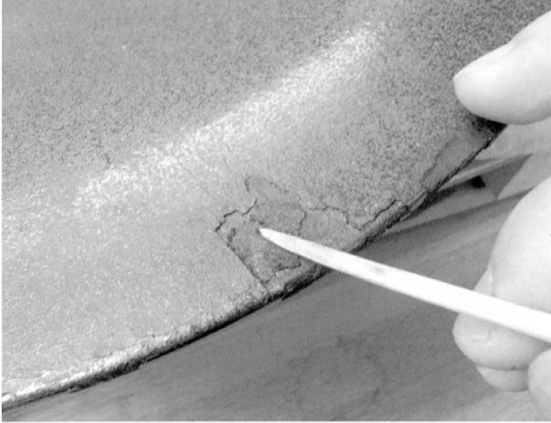
図25 刻蒔付け Fig. 25 Applying kokuso
