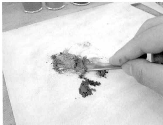
図22 刻苧材料 調合 Fig. 22 Making kokuso
