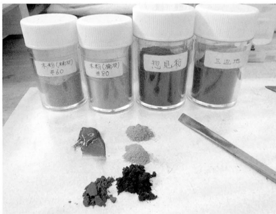
図21 刻苧 材料 Fig. 21 Materials for kokuso
