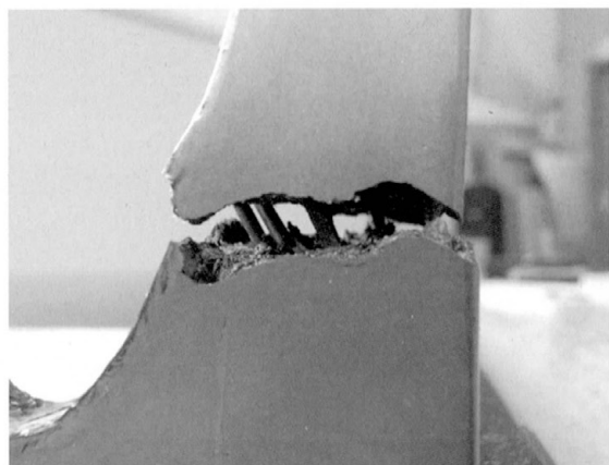
図19 脚 損傷部分 Fig. 19 Leg, damaged portion
