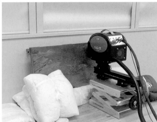
図10 蛍光X線 Fig. 10 X-ray fluorescence analysis
