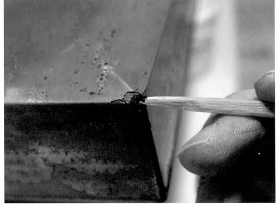
図 44 欠損部の充填 修復中
