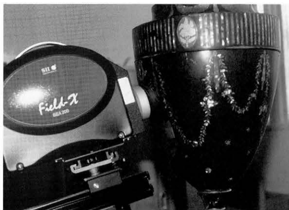
101 蛍光X線による金属分析 X-ray fluorescent analysis of makie
