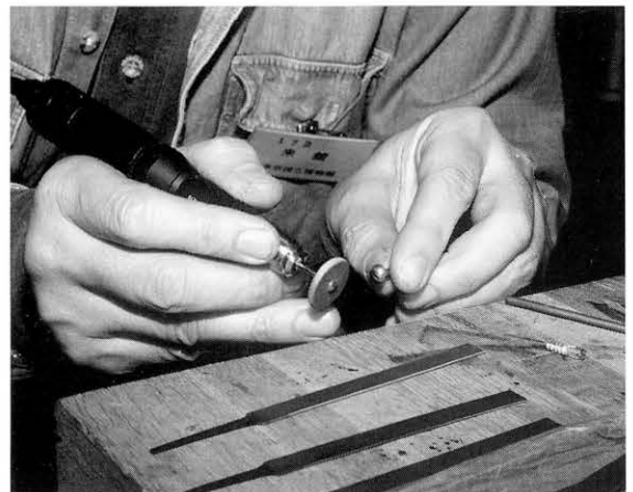
図115 破損したネジの復元 Restoring the damaged screw
