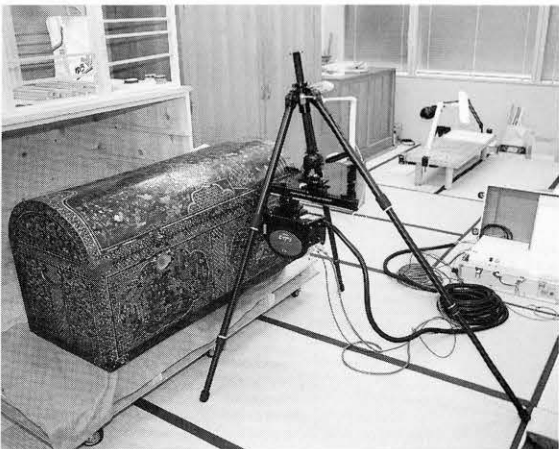
図144 蛍光X線分析による蒔絵粉の調査 Examining makie powder by X-ray fluorescence
