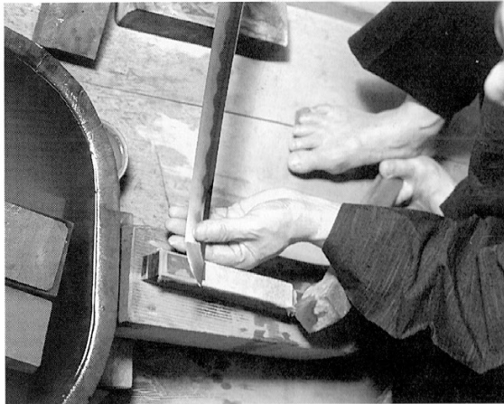
26 なるめ作業 Narume process
