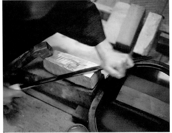
8 下地作業（名倉砥） Shitaji process (nagura-to)
