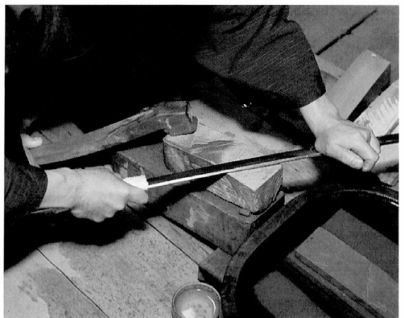
7 下地作業 (備水) Shitaji process (binsui-to)
