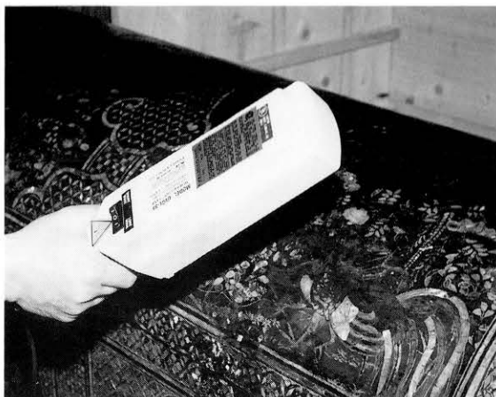
図258 紫外線照射器具による修復材料の調査 Photographing by ultra-violet light
