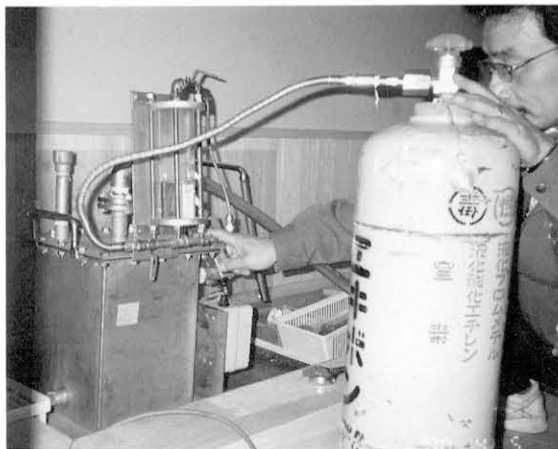
図107 修復後のエキボンガスによる殺虫 Killing insects with Ekibon gas after restoration
