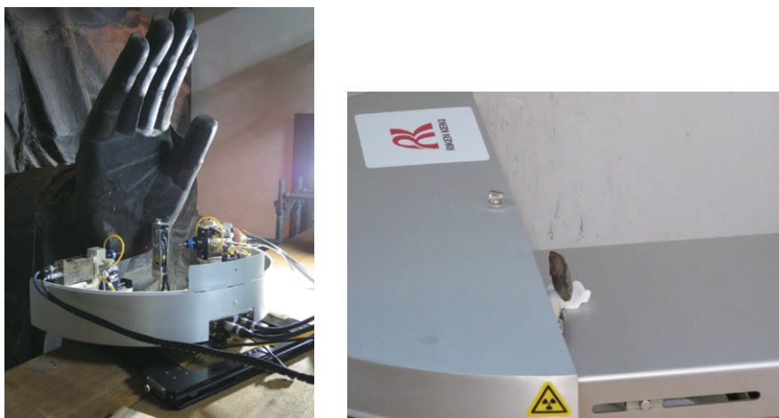
図3 可搬型X線回折分析装置を用いた(a)飛鳥大仏右掌下方部と(b)金属製断片の測定の様子
