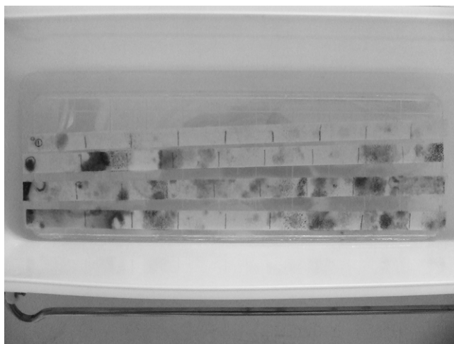
図3 湿度94% 8週で紙本、絹本にカビ発生が確認される (上から絹本糊無、紙本糊無、絹本糊有、紙本糊有)
