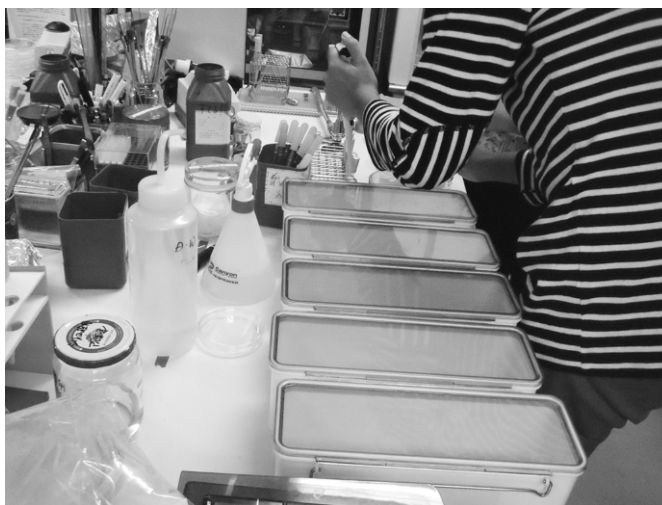
図1 密閉式試料試験容器5個を各湿度に安定させる
