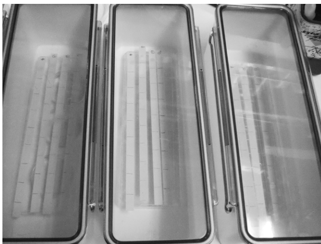
図2 試験容器内部に各カビ胞子を接種した紙本(糊無 糊有)および絹本(糊無 糊有)を設置
