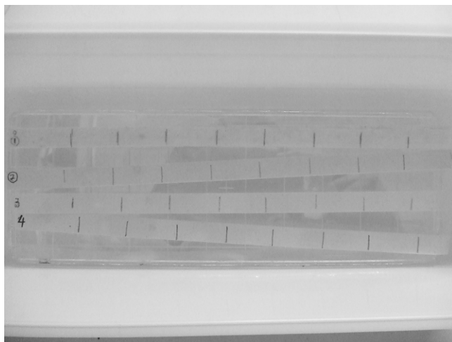
図4 湿度75% 20週でも紙本, 絹本でカビ発生が確認されない (上から絹本糊無, 紙本糊無, 絹本糊有, 紙本糊有)
