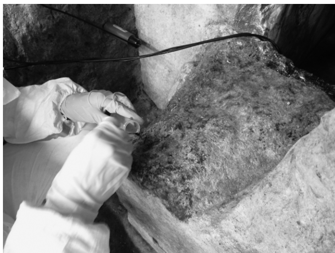
図6 閉塞石 盗掘口の下面 ウレタン・シリコンの下の石面の黒いカビ Phialophora sp. などのカビが検出された（試料8）
