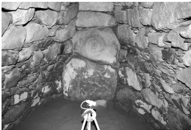
図3 石室内の温湿度計測 (古畑古墳)
