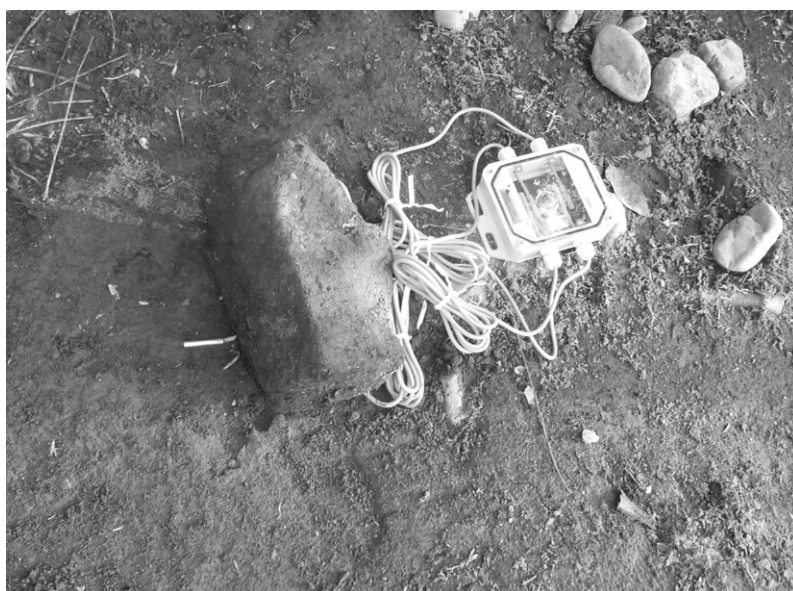
図 7. 温度センサーの設置状況
