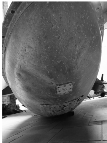
図14 船底 (穴埋めの様子)
