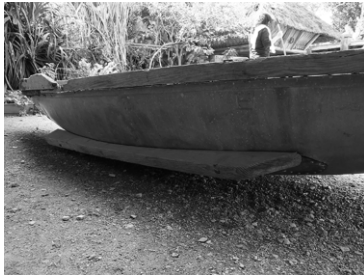
図29 ビルジキールと舷側
