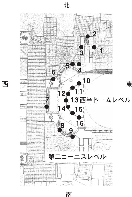
図3 西側外壁の削れ程度の計測場所
