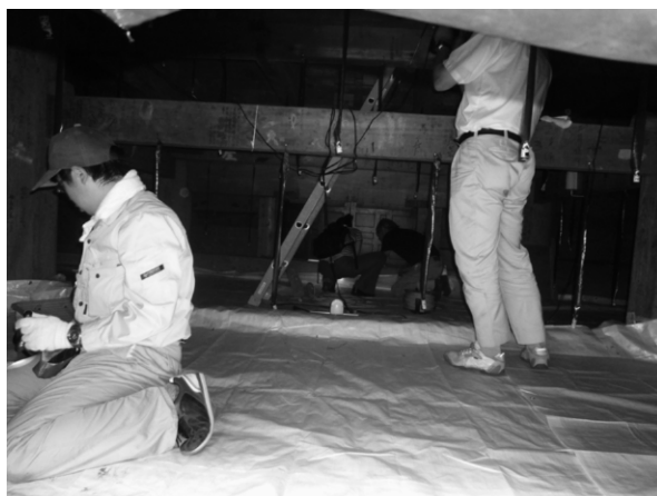
写真12 輪王寺大猷院二天門における落下虫の調査 予め床面を掃除したのち白いシートを敷いておき、落下虫を調査した。
