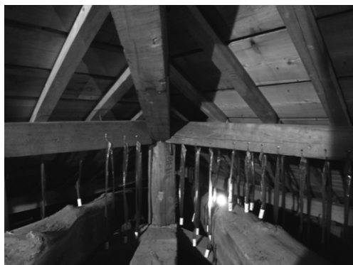
写真3 BEエリア（本堂裳階小屋裏，南東隅）（写真左），BWエリア（本堂裳階小屋裏，南西隅）（写真右）に設置されたLEDライト 2011年7月22日よりLEDライトを設置（24時間連続照射）。
