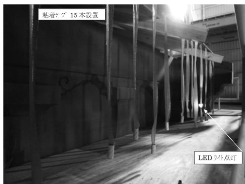
写真4 CEエリア（本堂裳階東面・外部）（写真左），CWエリア（本堂裳階西面・外部）（写真右）に設置されたLEDライト 2011年7月22日よりLEDライトを設置（24時間連続照射）。
