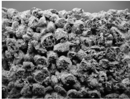
写真16 現地曝露試験後に生じた粒子の割れ (3-B拡大)
