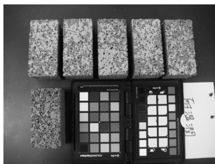
写真5 耐湿潤サイクル試験180サイクル終了後（4-B 下面）
