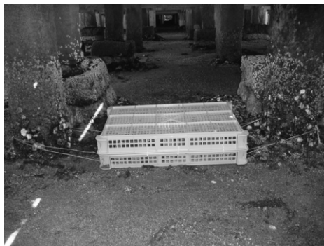
写真8 現地曝露試験コンテナ設置箇所
