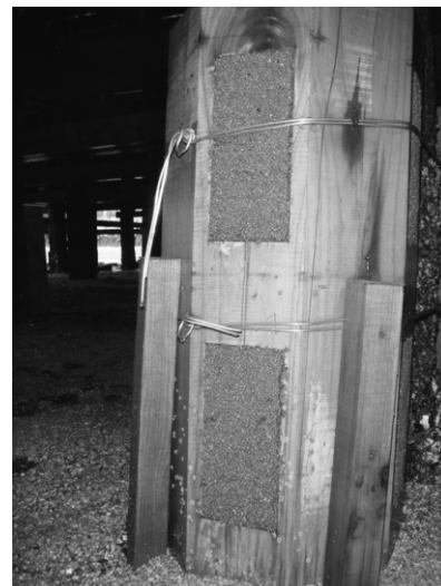
写真11 フジツボの着生(曝露開始3ヶ月後)
