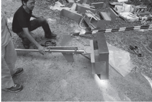
写真2 屋外用紫外線照射装置
