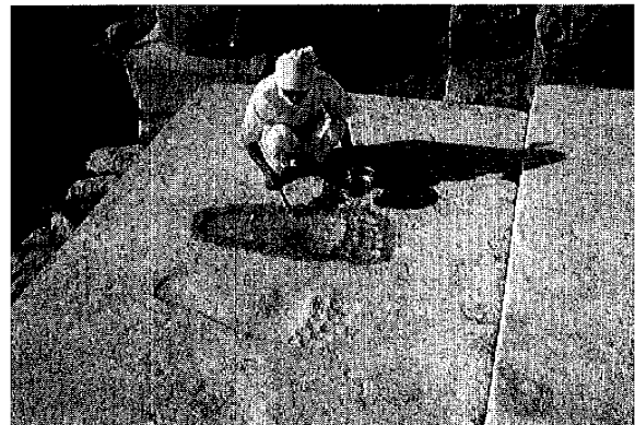
図 18 シリコン樹脂の塗布含浸による 足跡石の強化，保存処置
