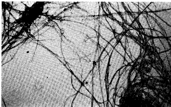
図一3 楮 B 3 離解 30 分間, 叩解 30 分間 Fig. 3 Kozo B 3 disintegration 30 min., beating 30 min.
