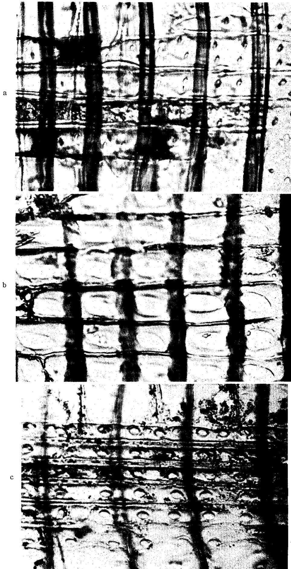
第12図 金色堂用材。柁目 a. ヒノキアスナロ b. コウヤマキ c. スギ 髄線細胞の分野の膜孔。a, b \times 500 , c \times 625
