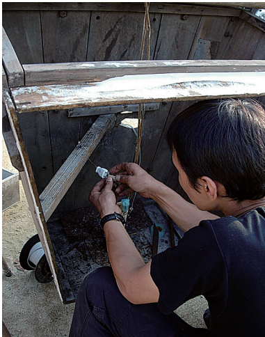
写真 15 流星箱には、背板とは別系統の着火装置を付ける。ここから大提灯とハンド提灯に点火する。
