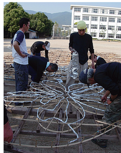
写真6 花火の桜の花を時間差で咲かせるため、火薬がすぐに回らないようアルミホイルで包む。
